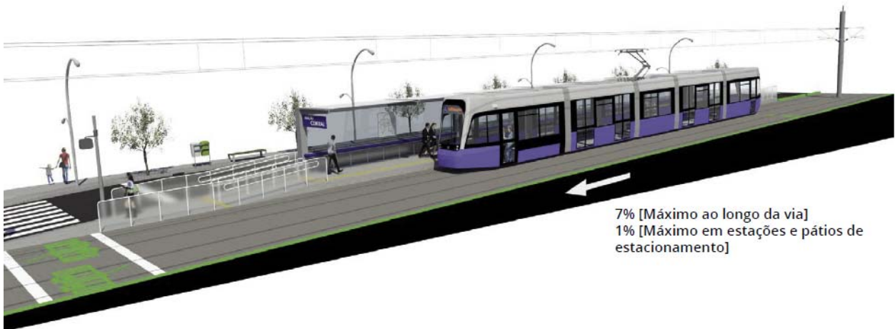
Figura 43. Rampas Máxima Permitida para o Greide do VLT
