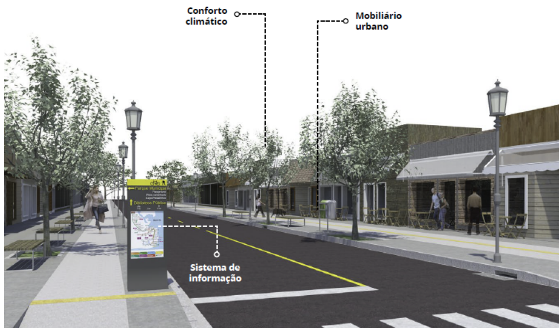
Figura 30. Elementos das calçadas – conforto, mobiliário e informação
