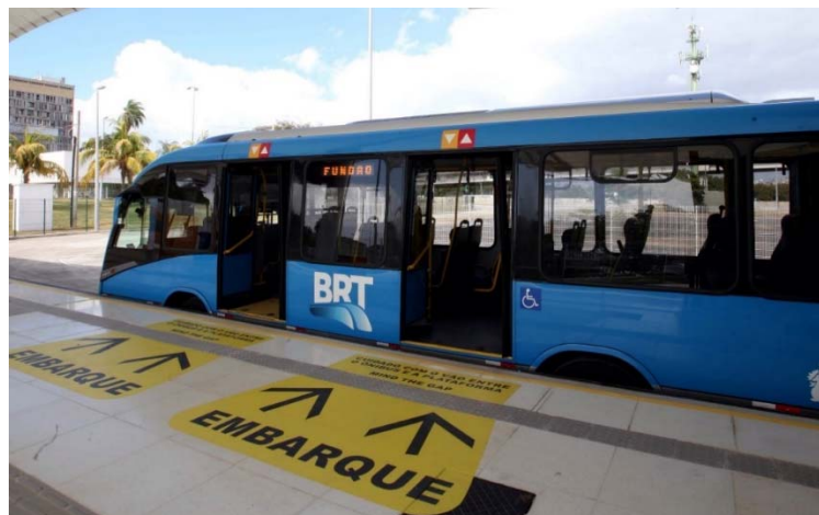
Figura 38. Plataforma de Embarque e Desembarque Nivelada ao Piso do Veículo
