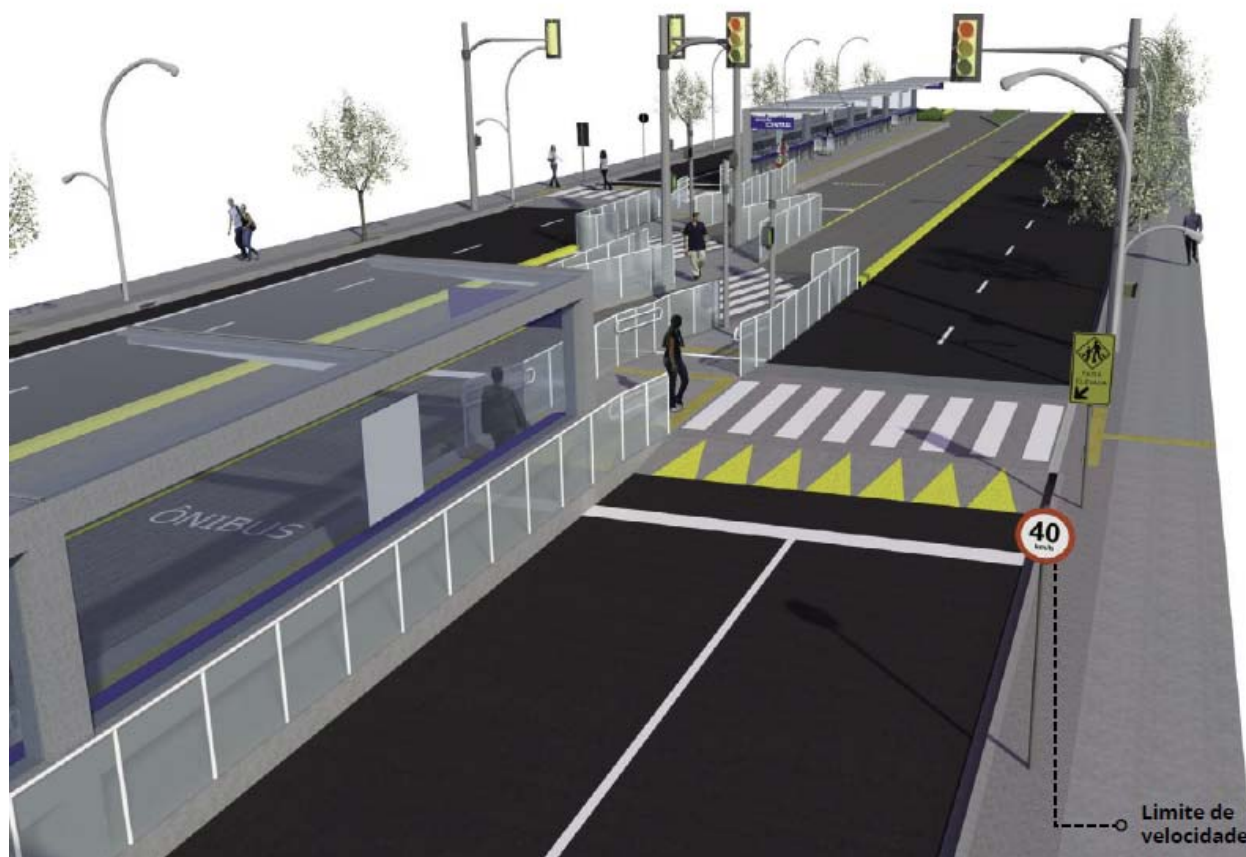
Figura 36. Corredor de ônibus Recomendado para a BR 226 – Esquema Ilustrativo Fonte: Caderno de Referência para Elaboração de Projetos de Mobilidade Urbana– Sistema de Prioridade ao Ônibus, página 121
