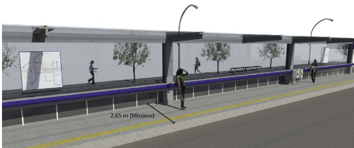
Figura 44. Largura Mínima Necessária para Acomodação de Estações de Embarque e Desembarque do VLT Fonte: Caderno de Referência para Elaboração de Projetos de Mobilidade Urbana– Veículo Leve sobre Trilhos, página 33
