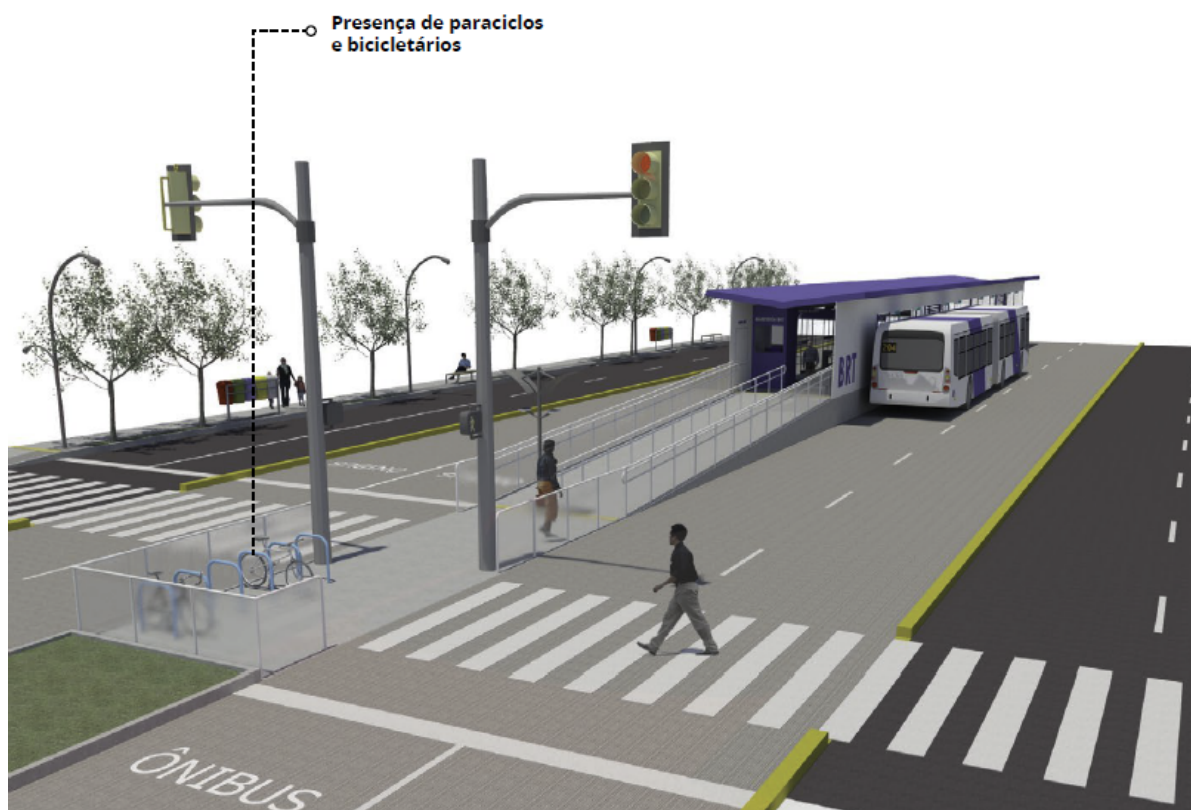
Figura 34. Paraciclos e bicicletários junto às Estações de Transporte Público – exemplo ilustrativo Fonte: Caderno de referência para elaboração de projetos de mobilidade – Transporte Ativo, página 46
