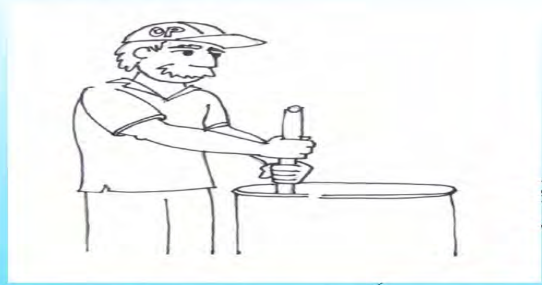
Ideal seria agitador mecânico; após tempo de agitação, decantar 10 min e após ligar dosadora
