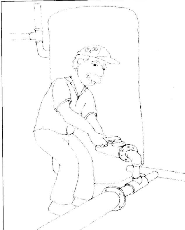
Com a bomba da captação desligada, Operador manobra registros para a retro lavagem: 1. Fecha entrada de água bruta; 2. Abre descarga de fundo até esgotar filtro e fecha em seguida; 3. Abre registro de entrada (tubo que vem da bomba de lavagem); 4. Abre registro do tubo de saída de água suja da lavagem
