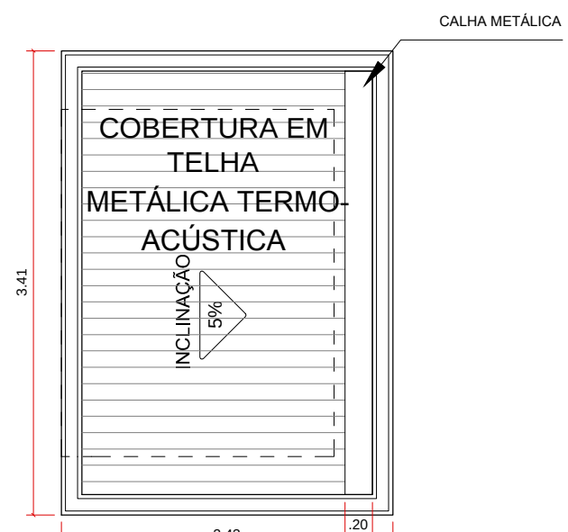
PLANTA DE COBERTURA GUARITA ESCALA 1: 50
